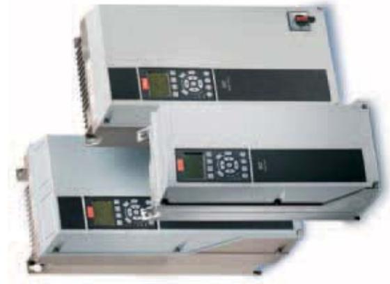
Sämtliche Komponenten wie EMV-Filter für Klasse A1/B1 nach EN 55011, sowie die Zwischenkreisdrosseln sind platzsparend und geschützt im Gerät integriert. Die Kabelzuführung erfolgt tropfsicher von unten durch die Bodenplatte. Der Kabelschirm lässt sich im Gerät auflegen, somit sind für die Durchführungen einfache und kostengünstige Kabelverschraubungen bereits ausreichend.
